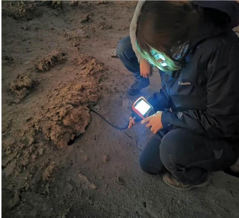
**Figura 20. Exploración de cavidad con cámara sonda marca RIDGID CA-350.** Fuente: Norte Andino EIRL.
