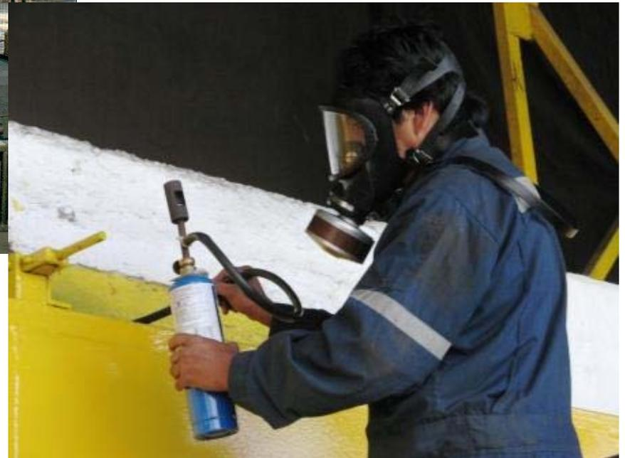
Proceso de inyección de fumigante y verificación de fugas
