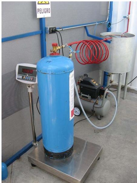
✓ Sistema de inyección a través de tuberías de bromuro de metilo, además del gas (Nitrógeno o aire comprimido) que permitirá realizar un barrido del excedente de Bromuro de Metilo en las tuberías.
