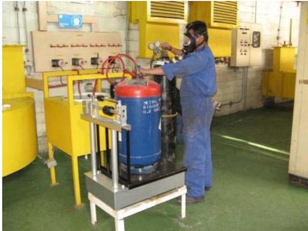
✓ Un sistema de evaporador para gasificar el Bromuro de metilo inyectado en la tubería. Se debe disponer de algún instrumento para verificar la temperatura del agua que contiene el sistema.
