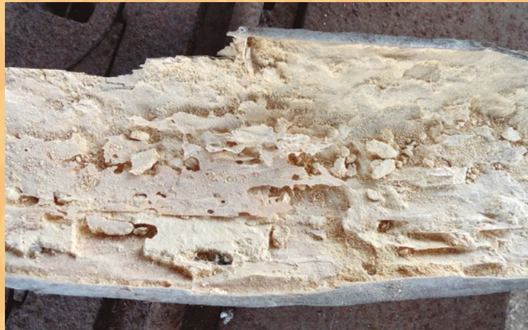
Madera destruida por acción de las larvas de Hylotrupes bajulus .
