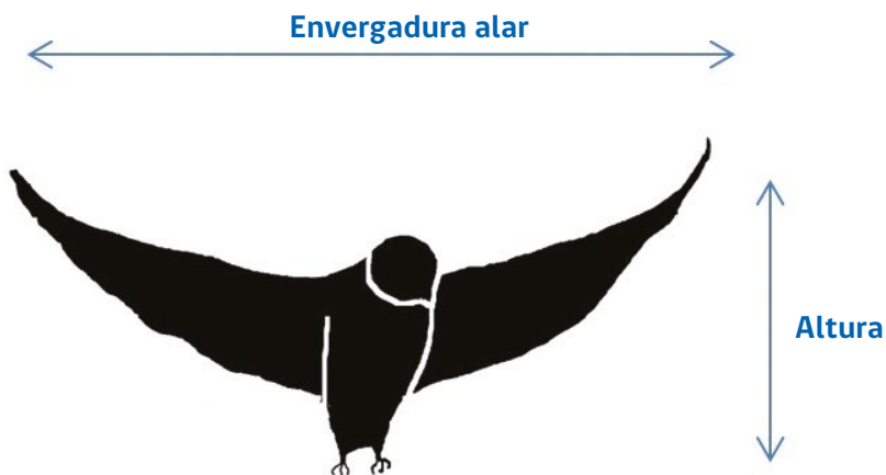
Figura 11: Se muestra la envergadura alar y la altura del ave, ambos factores inciden en la toma de contacto con dos fases energizadas.
