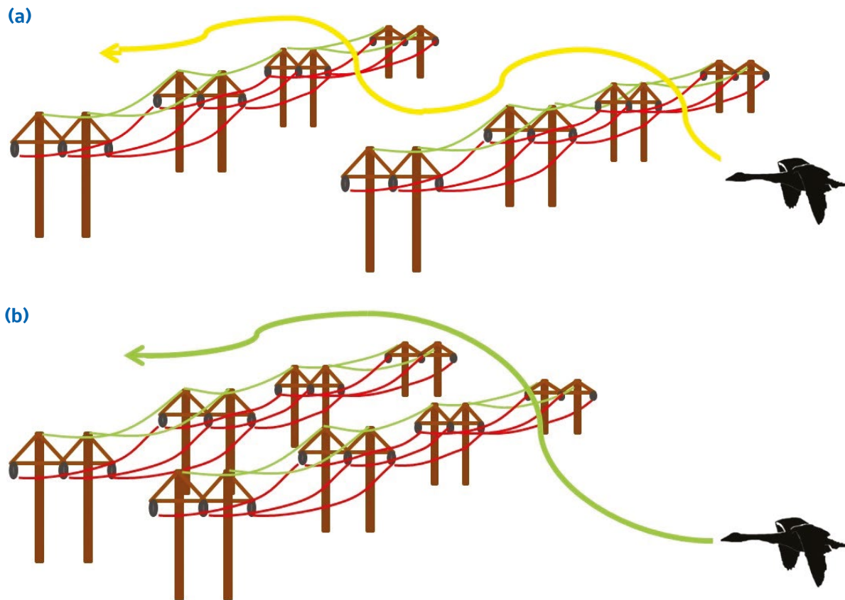
Figura 4: Reducción de riesgo de colisión al agrupar varios tendidos.
